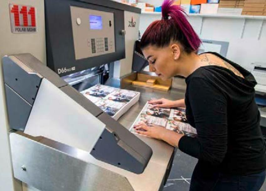
Die Medientechnologin schneidet die bedruckten Papierbogen exakt auf das gewünschte Format zu.
