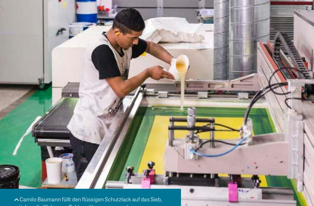
Camilo Baumann füllt den flüssigen Schutzlack auf das Sieb, mit dem die Kleber am Schluss überzogen werden.
