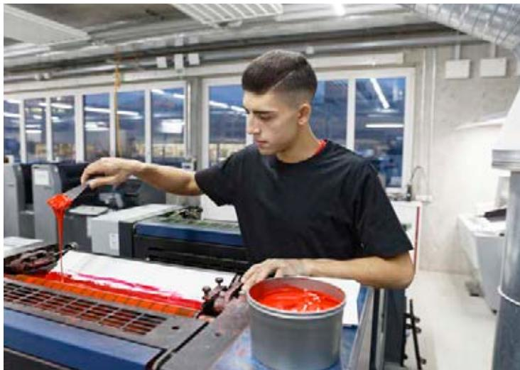
„Farbe einfüllen“ Der Medientechnologe füllt die Farben einzeln in die Bogendruckmaschine ein. Danach vergleicht er die Farbtöne des Probedrucks mit der Vorlage.
